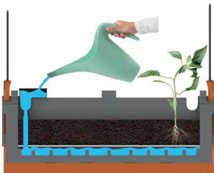
Attraverso il riempimento della riserva idrica di ogni vaschetta è possibile minimizzare la frequenza di bagnatura: le piante soddisfano il loro fabbisogno idrico tramite assorbimento dal basso. Per riempire la riserva idrica completamente a secco di una singola vaschetta sono sufficienti 0,5 litri d'acqua (non oltre). Il riempimento può essere richiesto circa 1 volta ogni 2/3 settimane.
